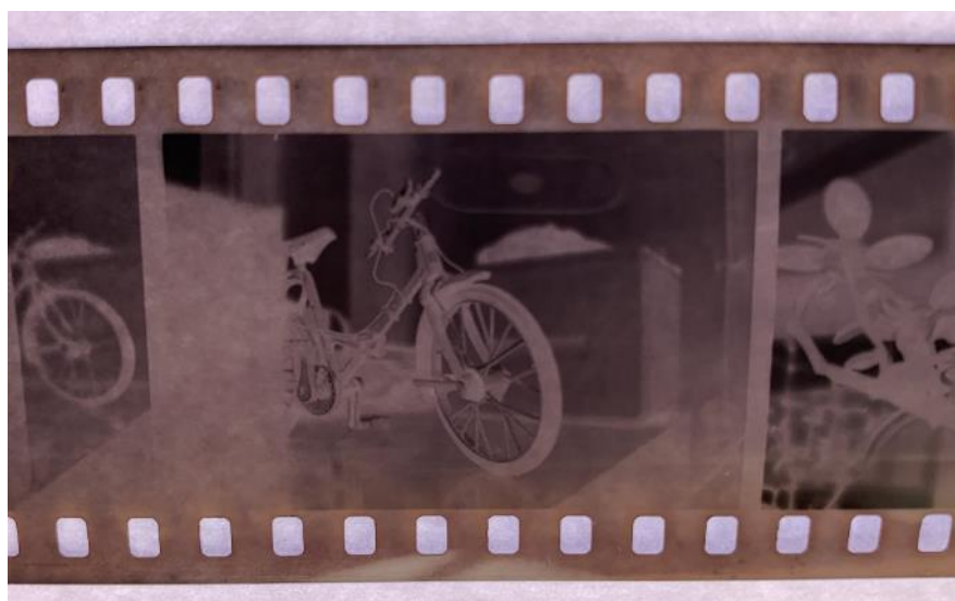
Figura 73 – Negativo fixado em solução de cloreto de sódio mais cebola.
