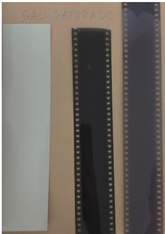
Figura 75 – Papel e película fotossensível fixada em solução de cloreto de sódio iodado.
