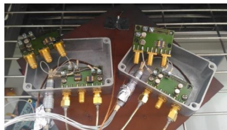
Figura 2.2: Dois módulos analógicos para sensores de emissão acústica e acelerômetros.
