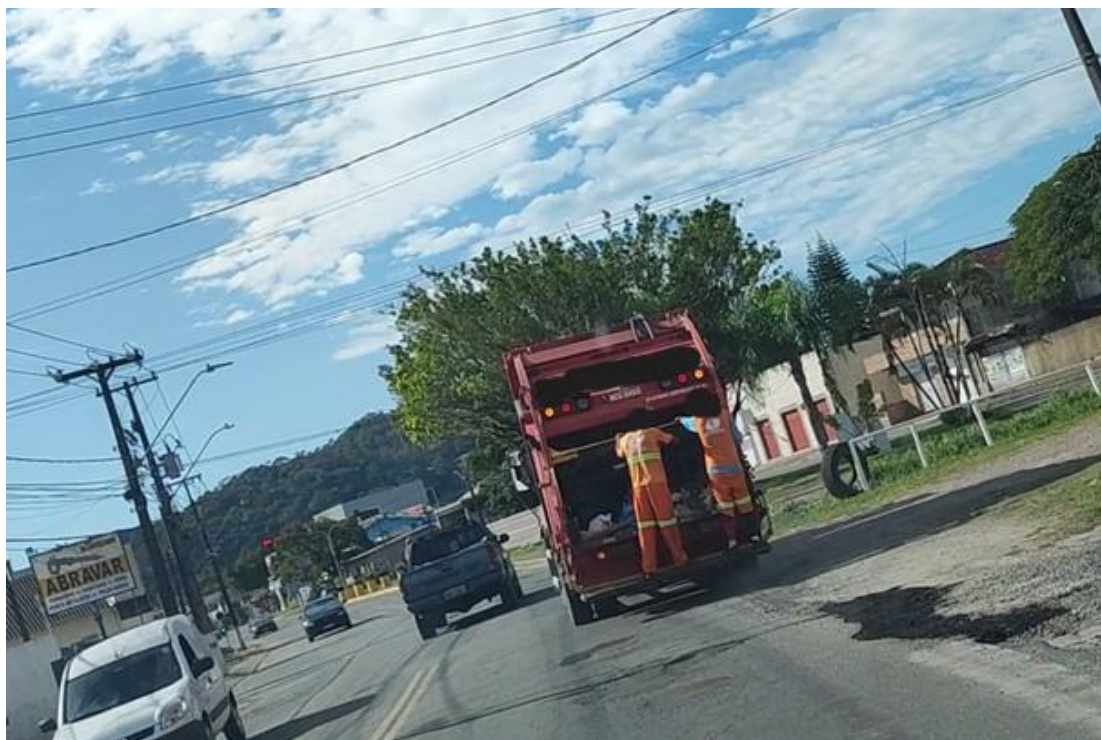
Figura 12 - Transporte de coletores sobre estribos do caminhão entre setores de coleta
