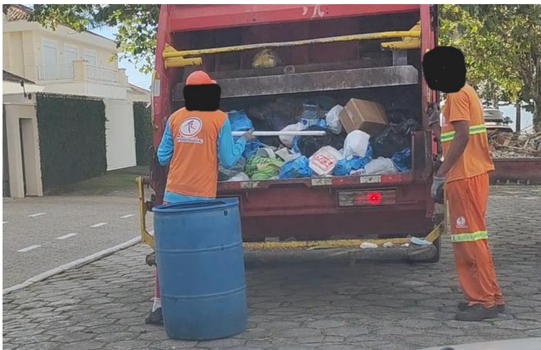
Figura 16 - Compactação de resíduos no coxo
