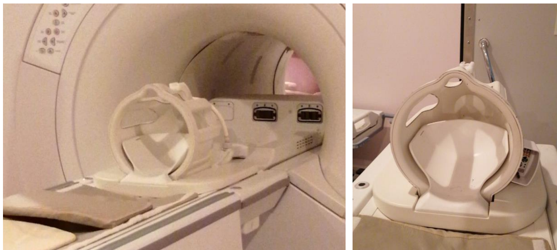
Figura 41 - Antena de RF do scanner GE, utilizada para a aquisição das imagens.
