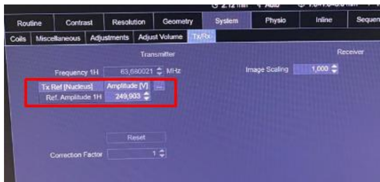
Figura 26 - Demonstração do ganho de transmissão (Ref. Amplitude 1H) no equipamento Siemens
