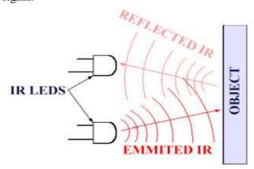
Fig. 3. Obstacle Sensor
