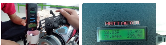
Gambar 12. Proses pengambilan data kecepatan putaran dan konsumsi arus motor
