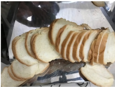
Gambar 6. Hasil pemotongan roti 600 rpm \pm 10\%
