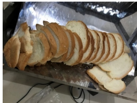
Gambar 7. Hasil pemotongan roti 1000 rpm \pm 10\%
