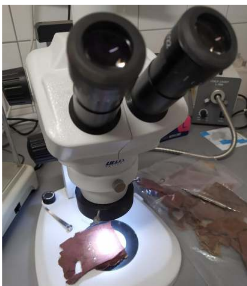
analiza splotów i gęstości przy użyciu mikroskopu ze światłem odbitym
