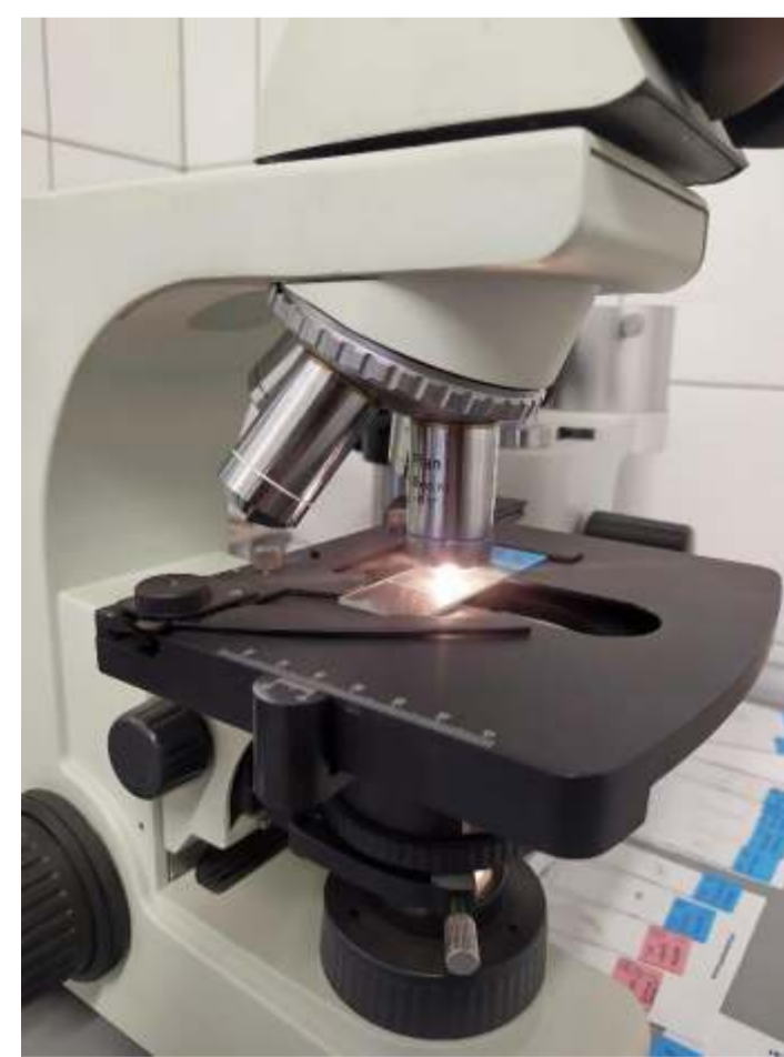
analiza surowca przy użyciu mikroskopu ze światłem przechodzącym
