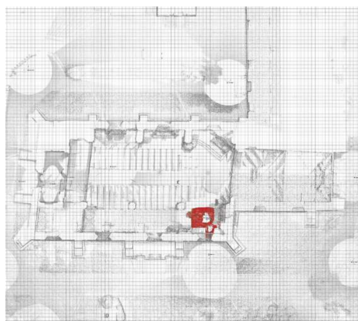
Przestrzenny model krypty uzyskany na podstawie danych z naziemnego skanera laserowego
