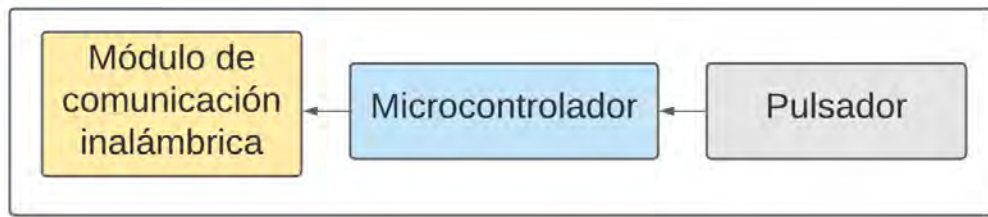
Figura 8. Diagrama de bloques del módulo botón de emergencia. Elaboración propia.
