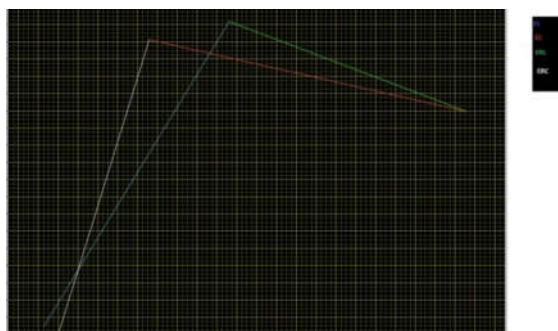
Figura 12: Ley de Kirchhoff de tensiones para la malla C, R_C , R_L y L: la tensión sobre la resistencia R_C blanca; Tensión sobre la resistencia R_L , verde; Tensión sobre el capacitor C, roja y la tensión sobre la inductancia L, azul. Observe que el pequeño segmento que falta para completar la poligonal corresponde a la caída en la resistencia interna del bobinado.
