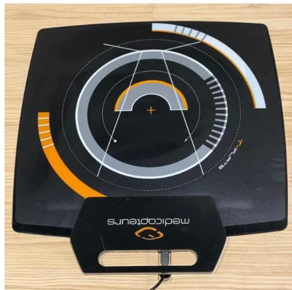
**Ilustración 7:** Plataforma de presiones portátil T-Plate. (Elaboración propia)
