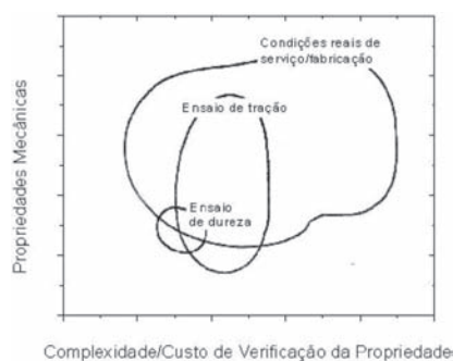
Figura 2.1 – Representação esquemática da relação entre a descrição das propriedades mecânicas de um componente sob condições reais de serviço/fabricação e pelo ensaio de tracção em relação ao custo/complexidade.
