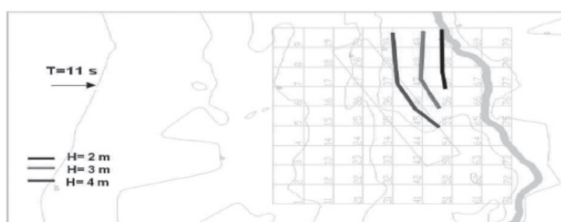
Figura 17 – Linhas de rebentação para a situação sem recife. Nível médio do mar. Onda incidente, T = 11\text{ s} e direção 220^\circ .
