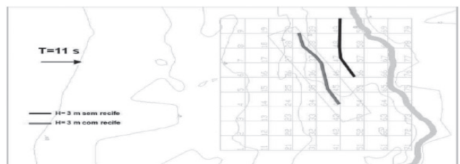
Figura 15 – Comparação entre as linhas de rebentação com e sem recife. Nível médio do mar. Onda incidente, T = 11\text{ s} , H = 3\text{ m} e direção 220^\circ .
