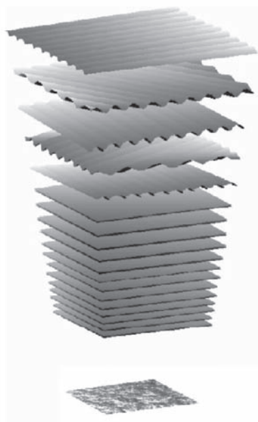
Figura 1 – Representação gráfica do princípio da sobreposição com várias ondas monocromáticas de diferentes características (Holthuijsen, 2007).
