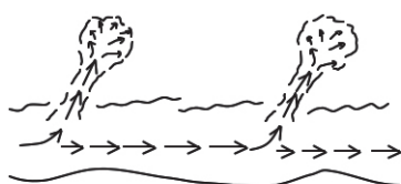
Figura 5: Corrente transversal de retorno criada por incidência quase perpendicular das ondas.
