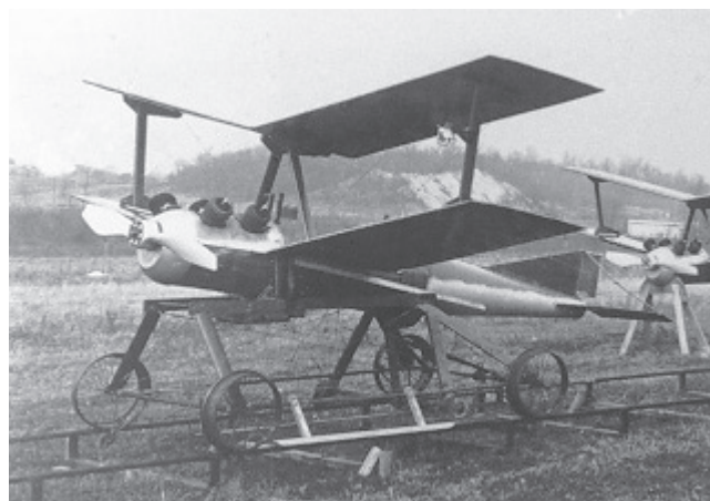
Foto do primeiro UAV: O Kettering Bug
