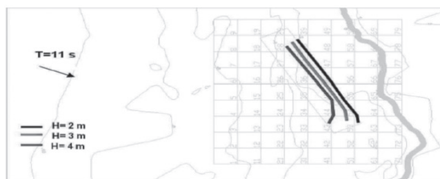
Figura 19 – Linhas de rebentação para a situação com recife. Nível médio de mar. Onda incidente, T = 11 s e direção 235^\circ .
