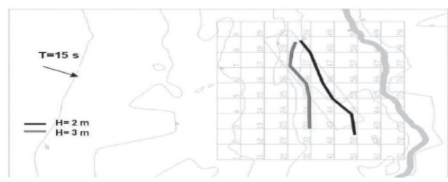
Figura 22 – Linhas de rebentação para a situação com recife. Nível médio de mar. Onda incidente, T = 15 s e direção 235^\circ .
