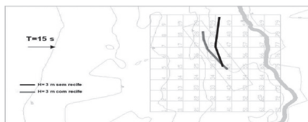
Figura 16 – Comparação entre as linhas de rebentação com e sem recife. Nível médio do mar. Onda incidente, T = 15\text{ s} , H = 3\text{ m} e direção 220^\circ .
