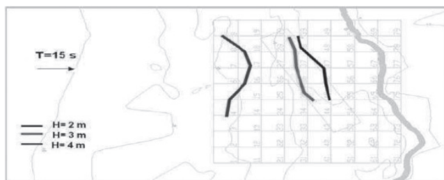
Figura 21 – Linhas de rebentação para a situação com recife. Nível médio de mar. Onda incidente, T = 15 s e direção 220^\circ .
