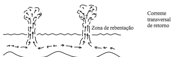
Figura 4: Corrente transversal de retorno criada por incidência perpendicular das ondas.
