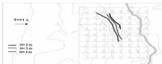
Figura 18 – Linhas de rebentação para a situação com recife. Nível médio do mar. Onda incidente, T = 11\text{ s} e direção 220^\circ .
