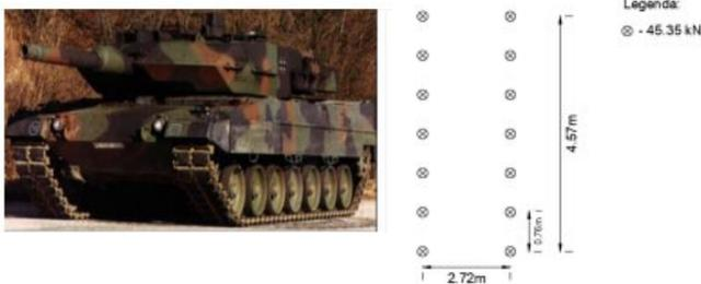
Figura 3. Da esquerda para a direita: Leopard 2 e Modelo de cálculo utilizado
