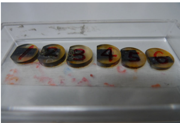
Fig. 5 Specimens for FE-SEM.
