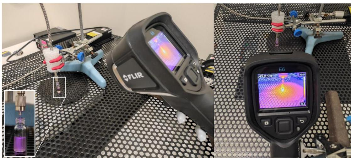
**Figura 35.** Montaje para el estudio del efecto fototérmico.
