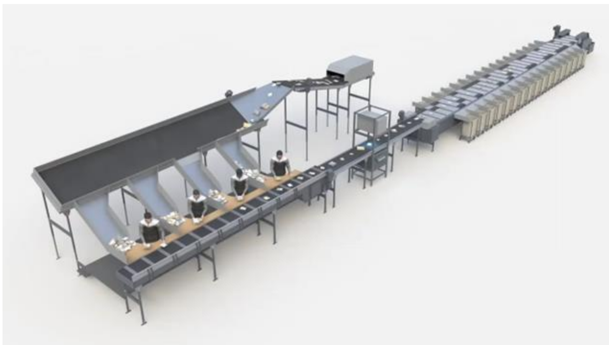
Figura 2.26 - Gated Conveyor para distribuição dos pacotes pelas induções
