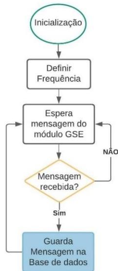
Figura 3.10: Fluxograma alusivo ao funcionamento do módulo Servidor.
