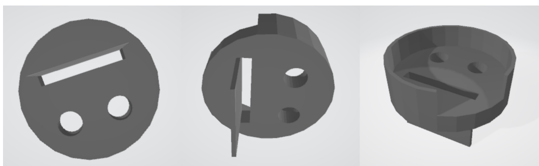
Figura 4.8: Desenho 3D da tampa produzida para o processo de eletrodeposição realizado no software SketchUp .
