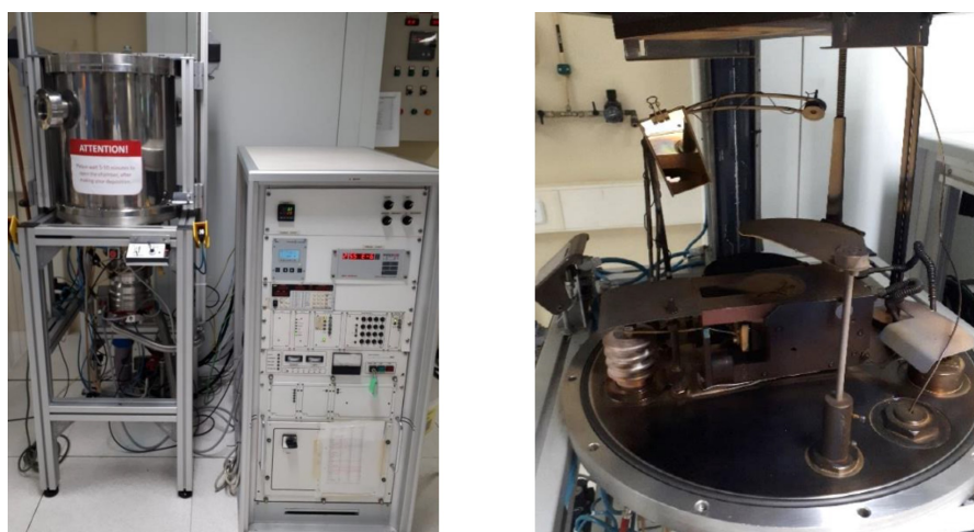
Figura 4.5: Sistema de e-beam . Vista geral de todo o sistema (esquerda) e vista mais detalhada do interior do sistema (direita).
