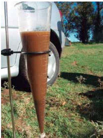
Foto 2. Análisis de sólidos sedimentables (SS) mediante cono Imhoff.
