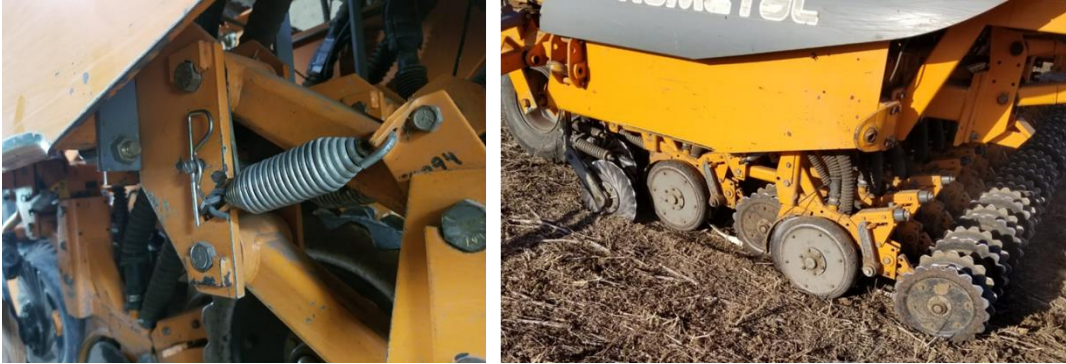
Figura 9. Resorte estabilizador del cuerpo de siembra
