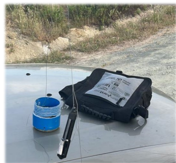
CTD instalado en el sondeo de control 4
