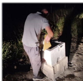
Medidas de nivel piezométrico
