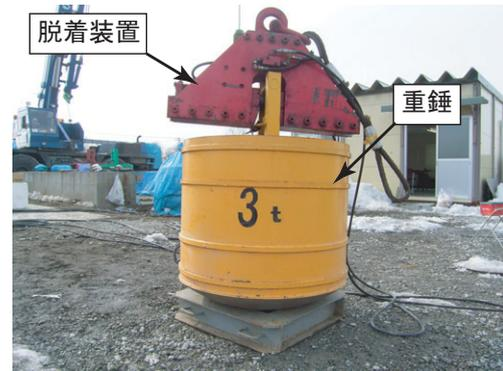
写真-1 重錘と脱着装置
