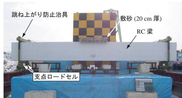
写真-2 RC梁の設置状況
