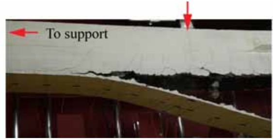
(b) Sheet debonding (Beam A-T0)
