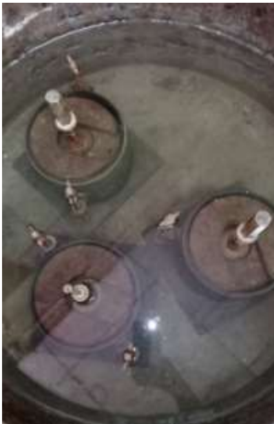
Figura 7. Muestras de suelo en condición de inmersión de 4 días para el CBR
