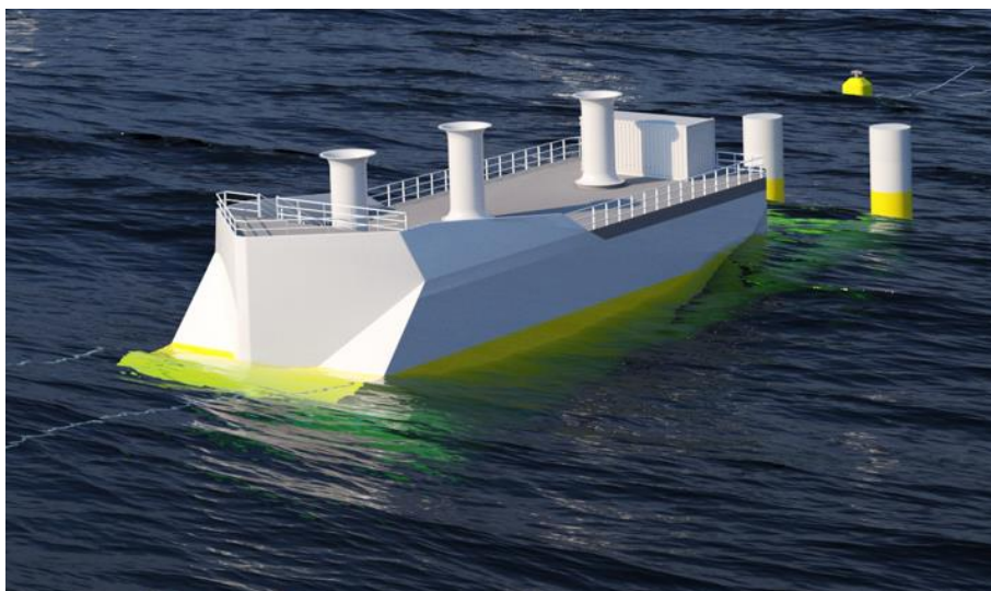
Figur 6: Skisse av eit 500 MW Offshore-klasse bølgekraftverk. Illustrasjon: Havkraft / NordWest3D
