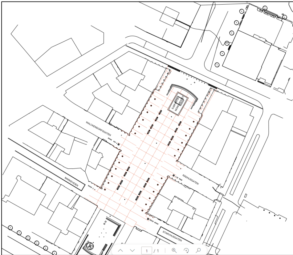
Figur 2.8 Torgalmenningen. Skissert/realisert inndeling med ekspansjonsfuger. Kilde: Next To Nothing (Tegning "Torgalmenningen – Oversiktsplan – A1". Ekspansjonsfuger, datert 30.04.98).
