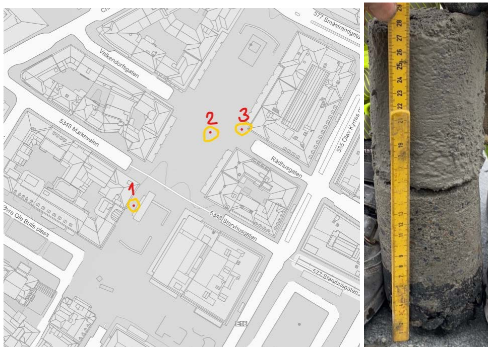
Figur 2.7 Plassering av prøver tatt av betongmørtel og asfaltgrus (venstre), og optatt prøve med 2 lag betongmørtel i prøvepunkt 2 (høyre).
