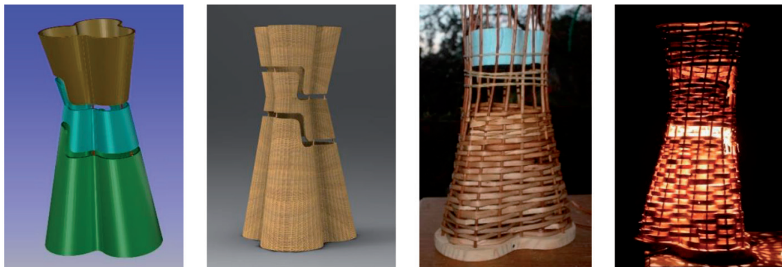
Fig. 4: Integración de herramientas digitales para el desarrollo del producto artesanal (modelos virtuales creados con Rhinoceros 5, para el proyecto ManBio)
