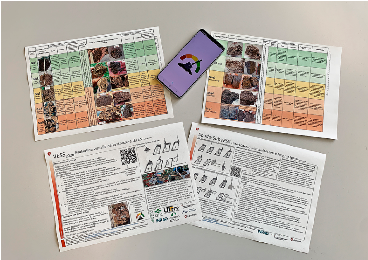
Abb. 3 | Die neuen Beurteilungsblätter für VESS 2020 und SpadeSubVESS werden auf einer A4-Seite dargestellt, mit einer Anleitung zur Entnahme der Probe auf der Vorderseite und Bildern und Erklärungen zur Beschreibung des Bodenziegels auf der Rückseite. Für die Nutzung mit Mobilgeräten steht die App VESS zur Verfügung. Foto: Alice Johannes, Agroscope.
