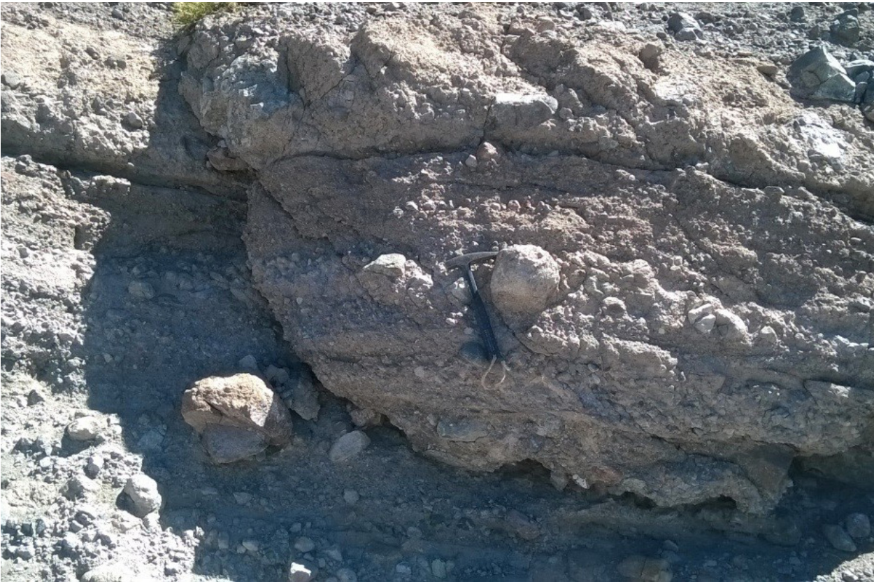
Figura 7: Aglomerado volcánico con alta permeabilidad perteneciente al Miembro Inferior del Complejo Volcánico Quebrada del Agua (Conde Serra 2017 y Seggiaro et al. 2018).
