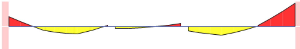
Figura N° 23: Diagrama de momento flector en viga peraltada con cargas de servicio
