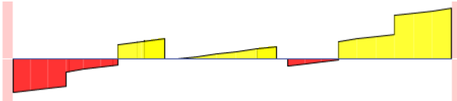
Figura N° 26: Diagrama de fuerza cortante en viga con cargas de servicio
