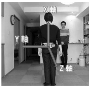
図1 腰に装着した加速度センサーとジャイロセンサー
