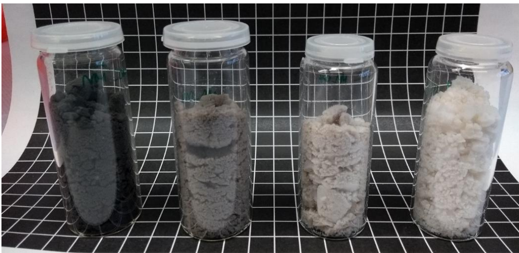
Abbildung 51 Beladungsreihe der mit Platin beladenen Indiumoxid-Aerogele mit einer abnehmenden Platinkonzentration von 5 m%, 2 m%, 1 m% und 0,5 m% von links nach rechts.
