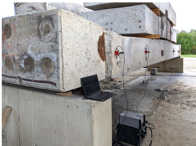
Bild 4: Der BTE-Träger für Messungen mit DAS und SEA
