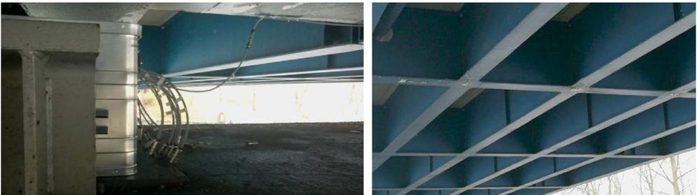
Bild 8: Messzentrale, eingerichtet auf der Widerlagerbank (links), Lage der Dehnmessstreifen im Messquerschnitt (rechts)
