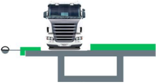
Bild 1: Beispiele von möglichen Betonierarbeiten an Brücken, bei welchen Erschütterungen auf den jungen Beton erzeugt werden (schematische Schnittdarstellung eines typischen Tragwerks; grau: Bestand; grün/blau: Neubau)
