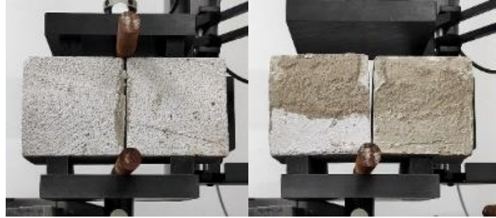
Gambar 10. Proses Sebelum dan Sesudah Pengujian Kuat Tarik Belah Pasangan Bata Ringan Thin Bed Mortar Mortar Instan (TBMM)
