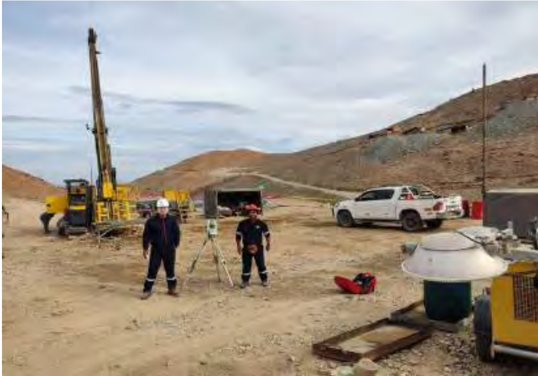
Medición de desviación de sondaje conjuntamente con el área de topografía.
