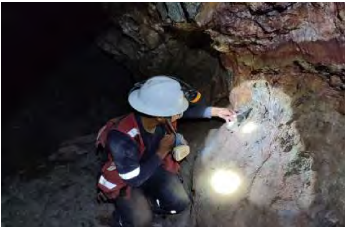
Toma de datos de las estructuras en interior mina para poder proyectar los sondajes.
