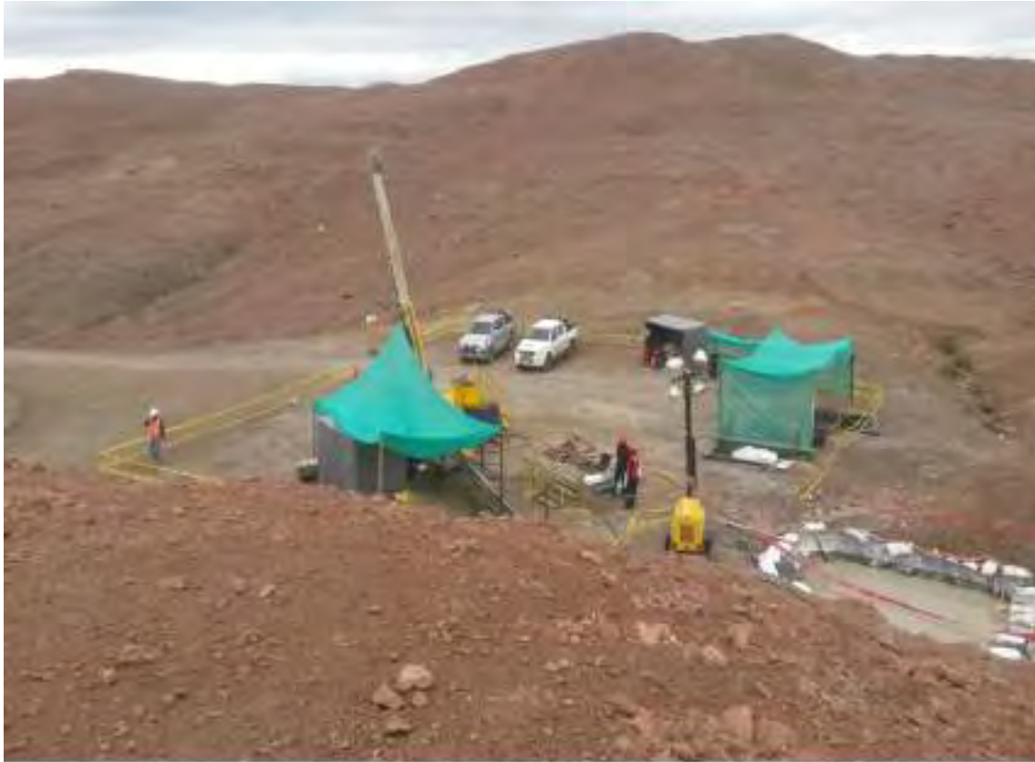
Plataforma de perforación diamantina en la concesión Santa Filomena.
