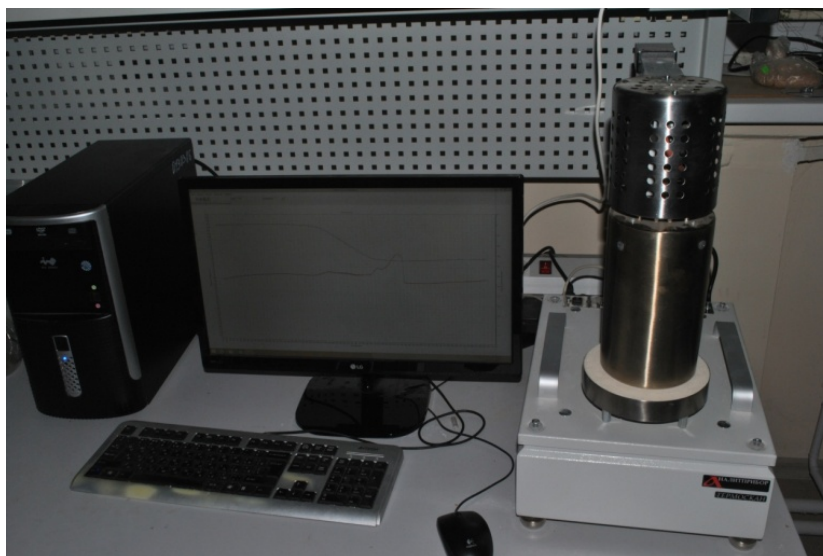
Рис. 1. Установка для дифференциально-термического анализа и термогравиметрического анализа Thermoscan-2 (USB, ТГА-модификация) Fig. 1. Differential thermal analyser and thermogravimetric analyser Thermoscan-2 (USB, TGA modification)
