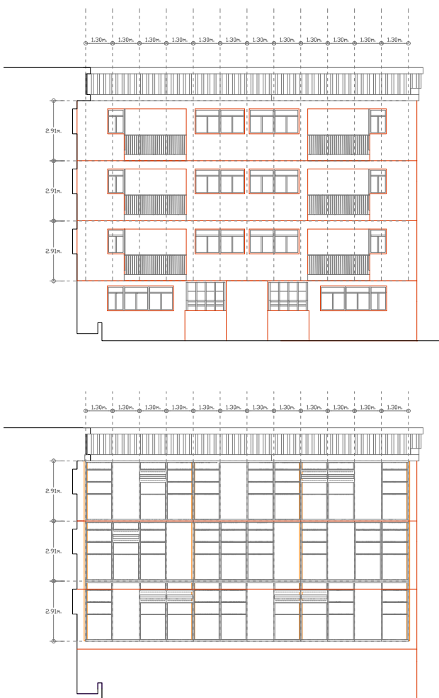
(Arriba) Despiece de celosías. (Debajo) Orden de instalación de celosías sobre fachada tipo. En orden: Fachada tipo, Bastidores y Celosía.
