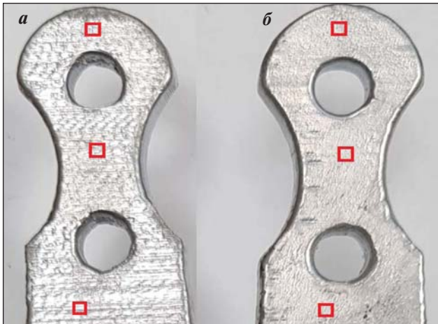
Рис. 5. Внешний вид отливки, полученной по выжигаемой необработанной модели (а) и после ее выдержки в дихлорметане (б)
