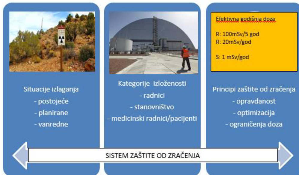
Slika 1: Sistem zaštite od zračenja se uspostavlja za sve situacije izlaganja i za sve kategorije izloženosti.
