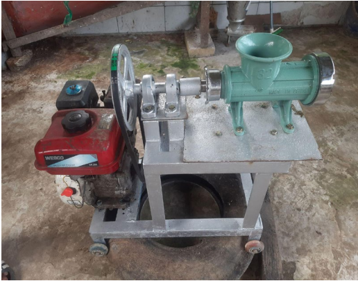
Gambar 3: Kondisi Alat Giling Pakan Ikan Setelah Perbaikan
