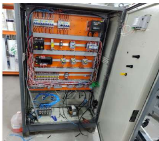
Figura 1 – Montagem do painel da bancada de testes
