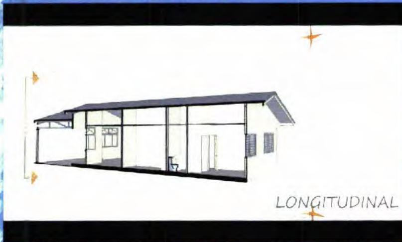
Luego que el plano de corte secciona el edificio, se remueve la parte restante, quedando visible el interior del edificio.
