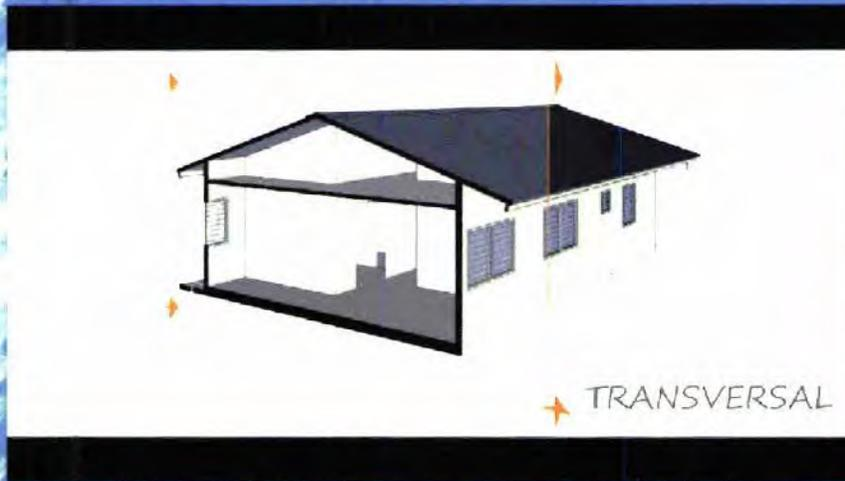
Luego que el plano de corte secciona el edificio, se remueve la parte restante, quedando visible el interior del edificio.
