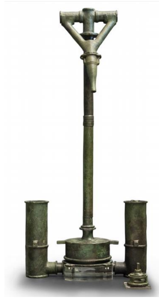
Figura 6. Bomba de força trobada a la mina de Sotiel Coronada amb la vàlvula horitzontal a la dreta. (Fernández Ruiz)
