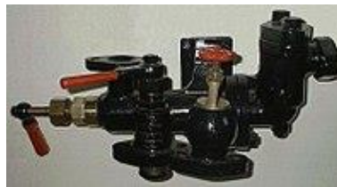
Figura 19. Bomba de vapor i injectors
