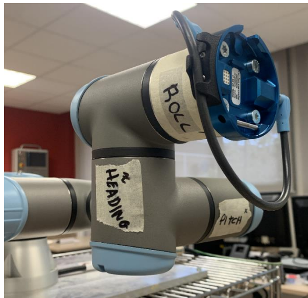
Ilustración 50. La Muñeca3(Roll Y), Muñeca 2 (Heading Z) y Muñeca 1(Pitch X). Fuente: Elaboración propia
