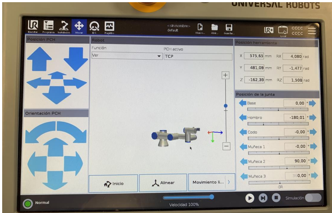
Ilustración 52. Posición inicial del UR3 e con los grados de cada motor. Fuente: Elaboración propia
