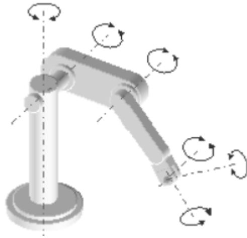
Ilustración 20. Distintos grados de libertad de un brazo de robot Fuente: Robots industriales.
