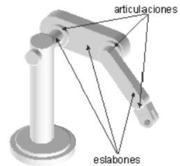
Ilustración 16. Elementos estructurales de un robot industrial.
