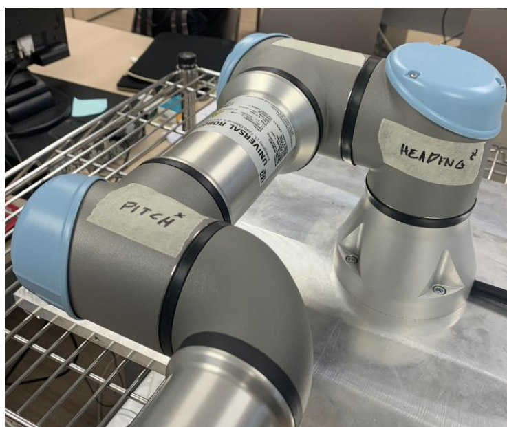
Ilustración 51. El Codo (Pitch X) y Base (Heading Z). Fuente: Elaboración propia
