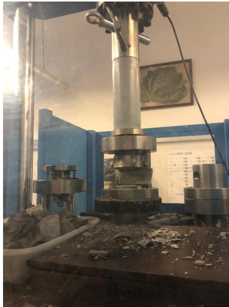
Figura 3.10. Assaig de compressió realitzat en premsa amb cèl·lula de càrrega de 300 kN.
