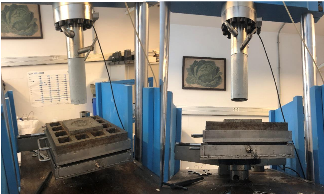
Figura 3.12. Preparació de la premsa per extreure l'aigua sobrant des de perspectives diferents.
