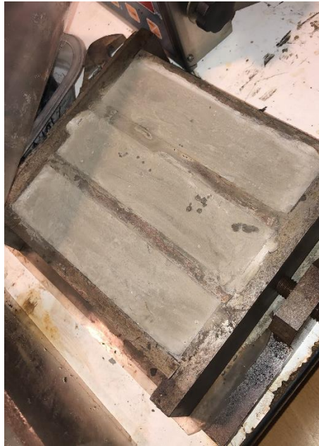
Figura 3.6. Motlle separat en 3 provetes de 4x4x16 cm
