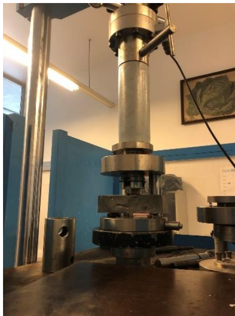
Figura 3.9. Assaig de flexió en 3 punts realitzat en premsa amb cèl·lula de càrrega de 300 kN.
