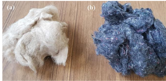
Figura 3.3. (a) Fibres llargues de lli (L); (b) Fibres curtes fetes de residu tèxtil (RT)
