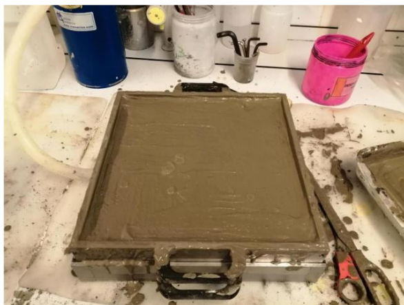
Figura 3.11. Sistema Hastchek amb càmera de buit incorporada.
