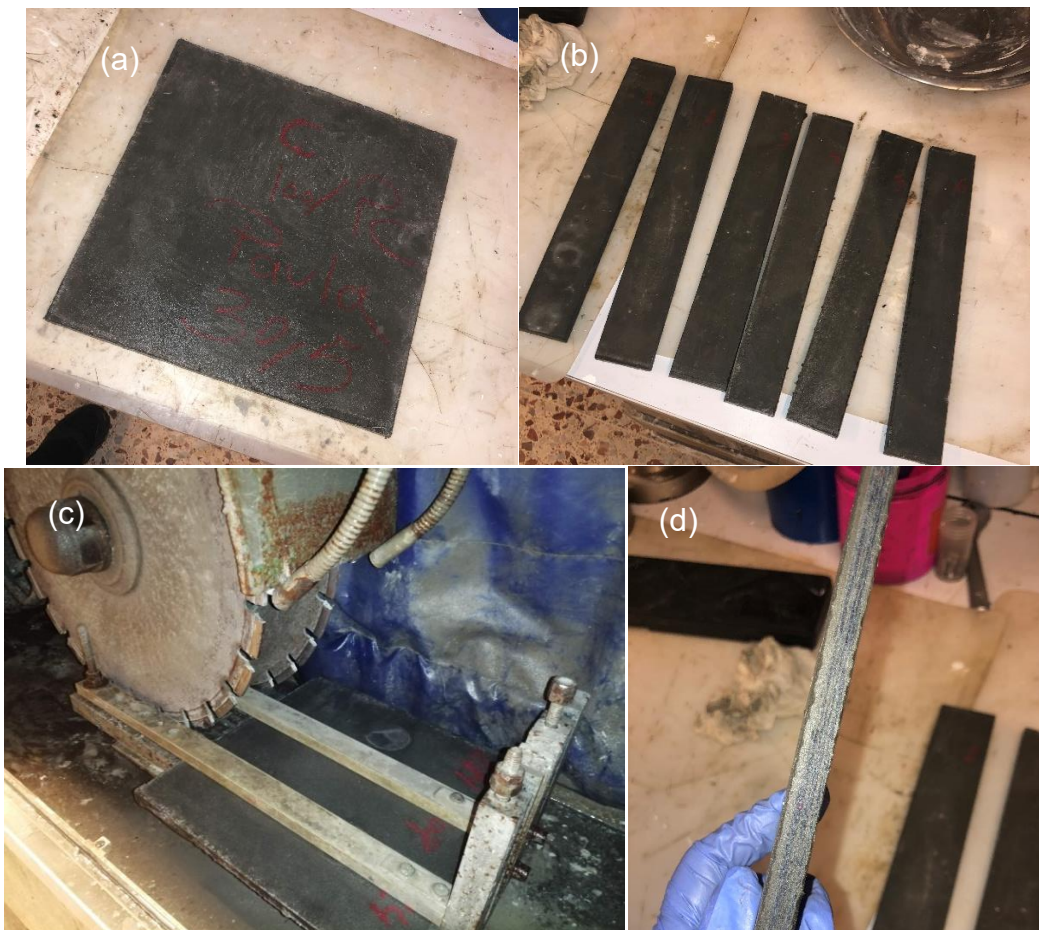
Figura 3.13. (a) Placa curada; (b) Placa tallada en 6 fragments; (c) Serra amb la que es van tallar les plaques; (d) Fragment de la placa en el que es poden apreciar les 6 capes de fibra.
