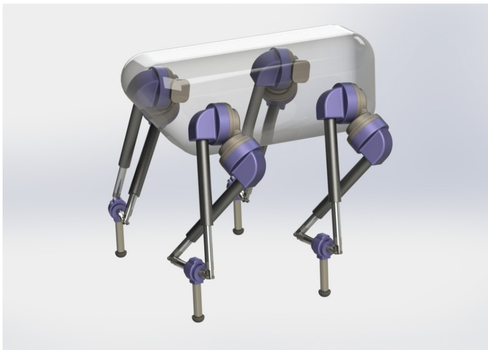
Figura 6.2. Proposta de la implementació del mecanisme complet instal·lat en el cos genèric d'un robot quadrúpede en estàtic.
