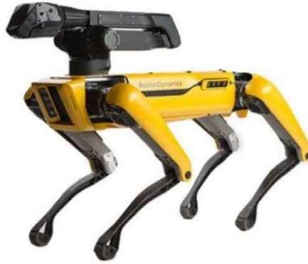
Figura 2.25. Robot Spot. En aquesta imatge en concret porta l'accessori del braç articulat amb 5 graus de llibertat. [Biswal & Mohanty, 2021]
