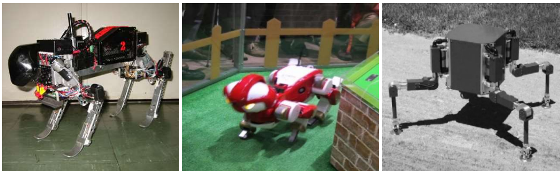
Figura 2.12, 2.13 i 2.14. A l'esquerra:TEKKEN-2 [Kimura & Kodono, s.f.], al centre: TEKKEN-4 [Biswal & Mohanty, 2021], els dos prototips capaços de caminar i galopar. A la dreta: SILO4 [Biswal & Mohanty, 2021], desenvolupat a Espanya i centrat en l'estabilitat.
