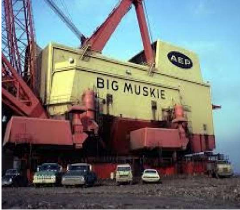
Figura 2.5 i 2.6. “The Big Muskie”, una grua de 13500 tones capaç de desplaçar-se amb quatre potes hidràuliques. [Biswal & Mohanty, 2021] [www.wikipedia.org]
