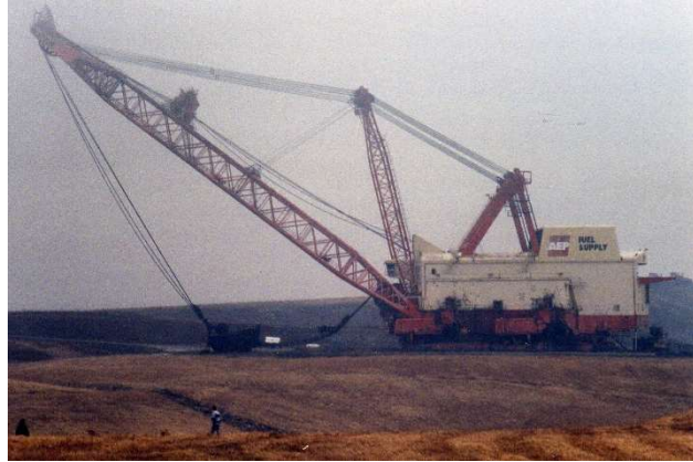
Figura 2.5 i 2.6. “The Big Muskie”, una grua de 13500 tones capaç de desplaçar-se amb quatre potes hidràuliques. [Biswal & Mohanty, 2021] [www.wikipedia.org]
