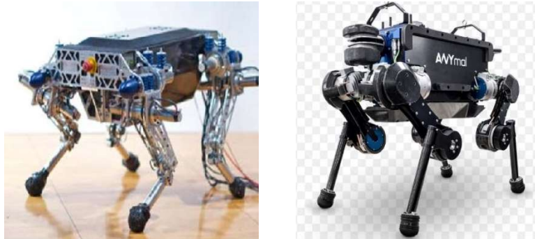
Figura 2.20 i 2.21. A l'esquerra: Star1ETH, robot capaç d'emmagatzemar energia. A la dreta: ANYmal, primer prototip d'una sèrie de robots comercials. [Biswal & Mohanty, 2021]
