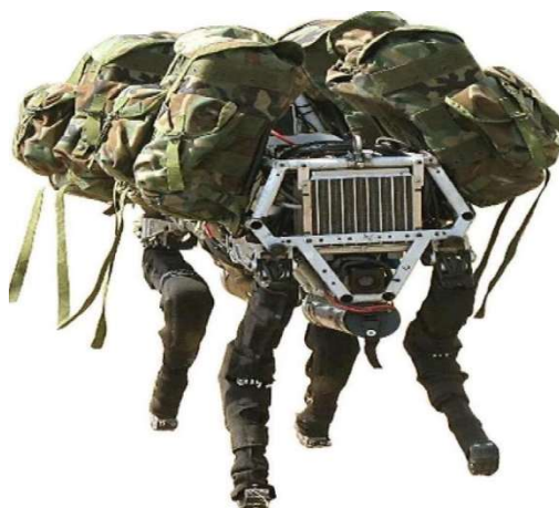
Figura 2.24. Big Dog 2nd Generation, robot desenvolupat per Boston Dynamics propulsat amb un motor de combustió interna. [Biswal & Mohanty, 2021]
