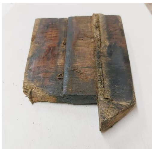
Il·lustració 31: Dent extreta de la turbina
