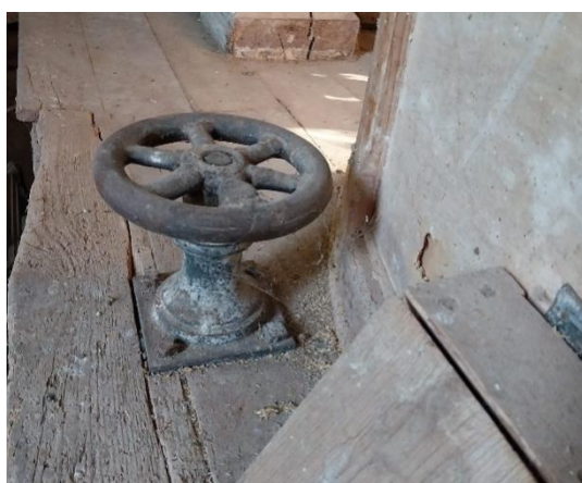
Il·lustració 22: Sistema regulador d'alçada de les moles. Rodet
