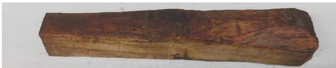
Il·lustració 29: Tascons extrets dels engranatges
