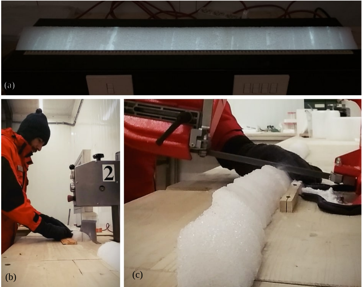
Figura 4.4: (a) estratigrafia sob luz, as linhas mais claras são lentes de gelo; (b) o segundo corte longitudinal do testemunho; (c) o corte transversal a cada 5 cm gerando às frações destinadas à análise da poeira.
